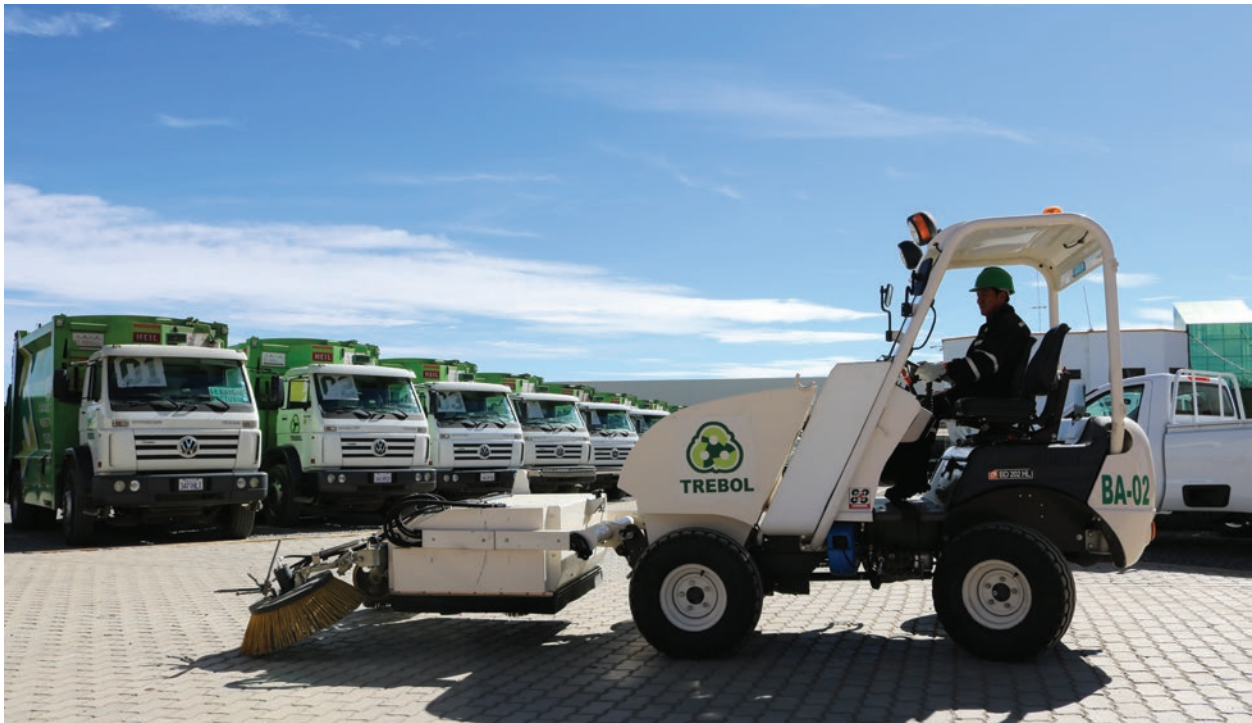
Motobarredora y camiones de recolección carga trasera de la empresa TREBOL S.A.
